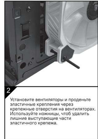
2 Установите вентиляторы и проденьте эластичные крепления через крепежные отверстия на вентиляторах. Используйте ножницы, чтобы удалить лишние выступающие части эластичного крепежа.
