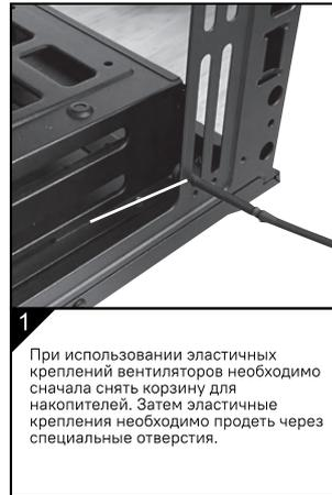
1 При использовании эластичных креплений вентиляторов необходимо сначала снять корзину для накопителей. Затем эластичные крепления необходимо продеть через специальные отверстия.
