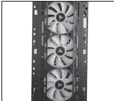
Установите 12 см вентиляторы на внутренней части каркаса передней стенки корпуса. Зафиксируйте их винтами. Для укладки проводов можете использовать специальные каналы.
