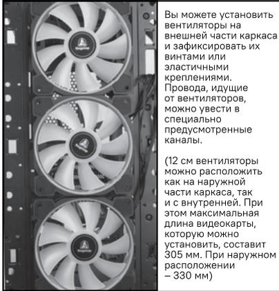
Вы можете установить вентиляторы на внешней части каркаса и зафиксировать их винтами или эластичными креплениями. Провода, идущие от вентиляторов, можно увести в специально предусмотренные каналы.
