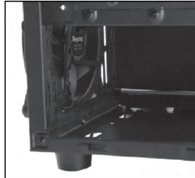
При креплении винтами Перед установкой вентиляторов необходимо демонтировать корзину накопителей для более простого доступа. Расположите вентилятор на каркасе, сопоставьте отверстия и закрепите вентиляторы винтами. Установите корзину накопителей обратно.
