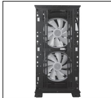
На передней внутренней части передней стенки каркаса можно установить два 12 см вентилятора. Фиксация вентиляторов осуществляется винтами.
